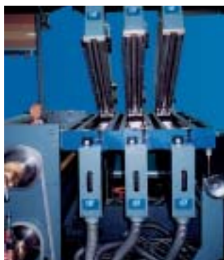
UV-Härtung im Rollenbereich UV curing in the field of web-offset
